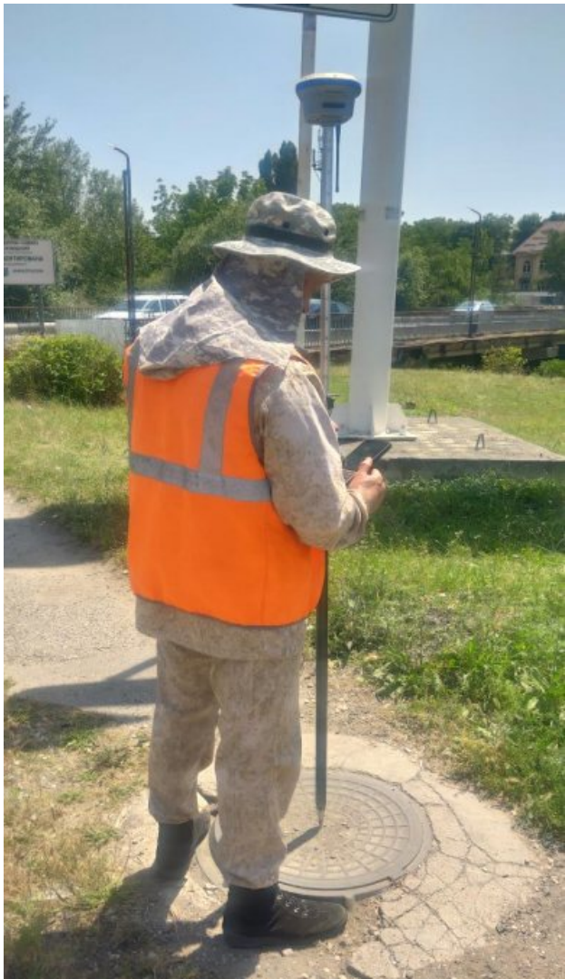
Съемка геодезической спутниковой аппаратурой PrinCe i90
