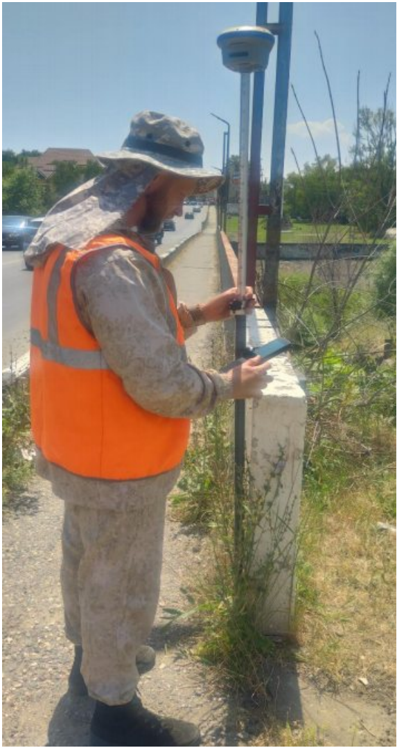
Съемка геодезической спутниковой аппаратурой PrinCe i90
