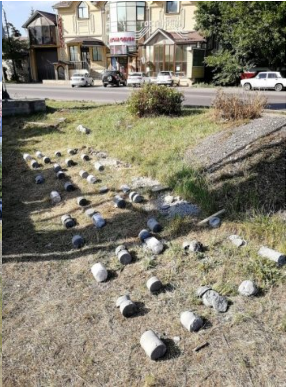
Фото 6. Керна выбуренный из С-2, буровой установкой УРБ-51
