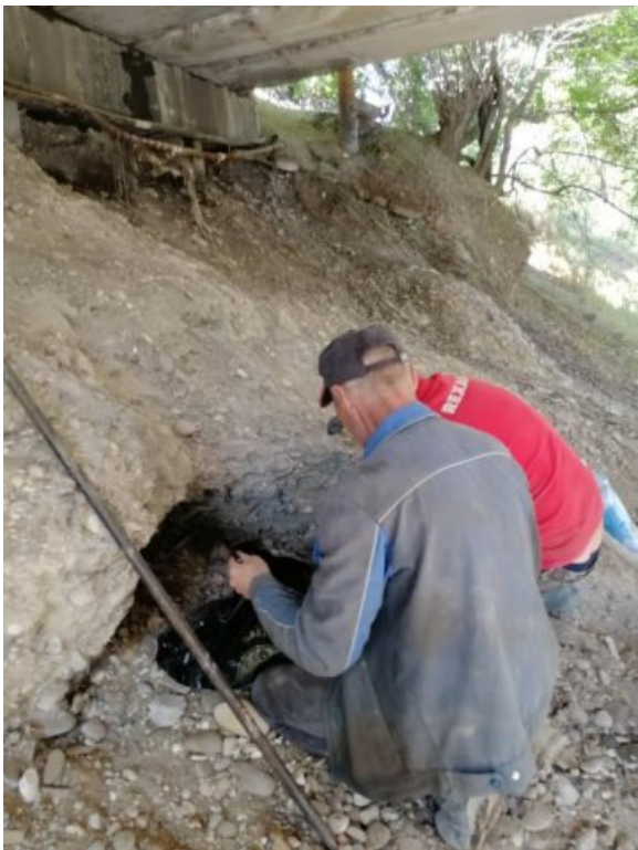
Фото 19. Определение плотности щебенистого грунта, методом «Мерной лунки» в шурфе 7
