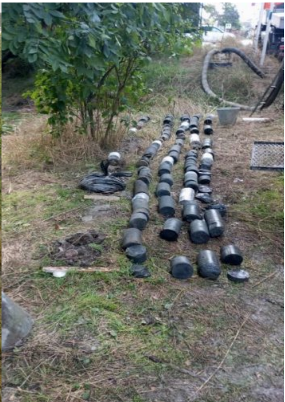
Фото 8. Керна выбуренный из С-4, буровой установкой УРБ-51
