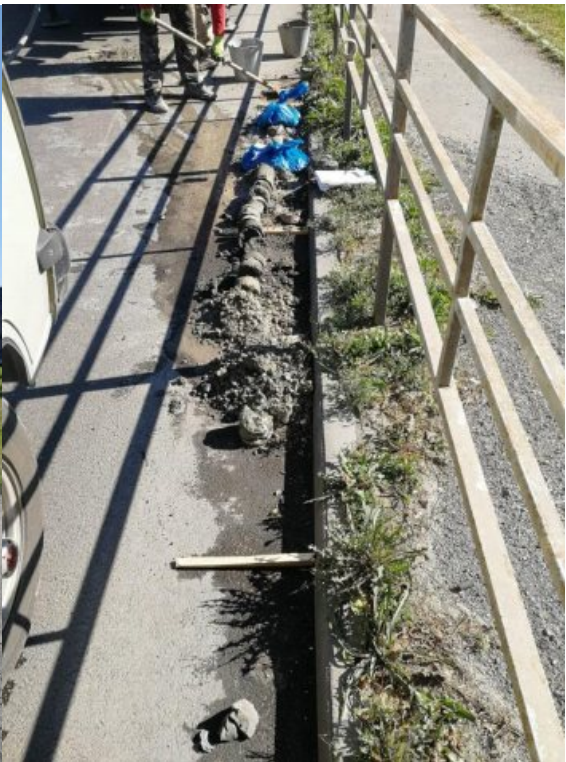
Фото 16. Керна выбуренный из С-7, буровой установкой УРБ-51
