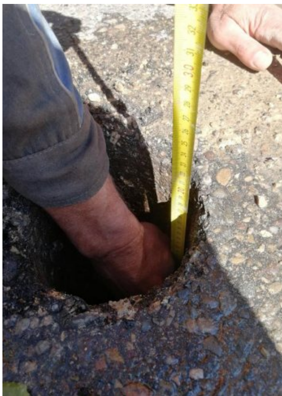
Фото 11. Замер мощности асфальтобетона в С-5, по ул. Этокской в ст. Ессентукской
