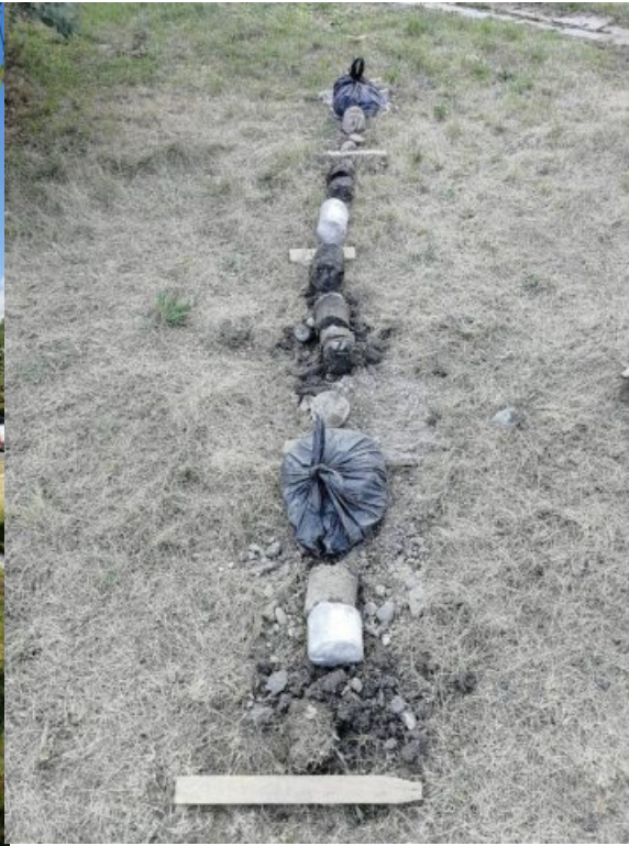
Фото 14. Керна выбуренный из С-6, буровой установкой УРБ-51
