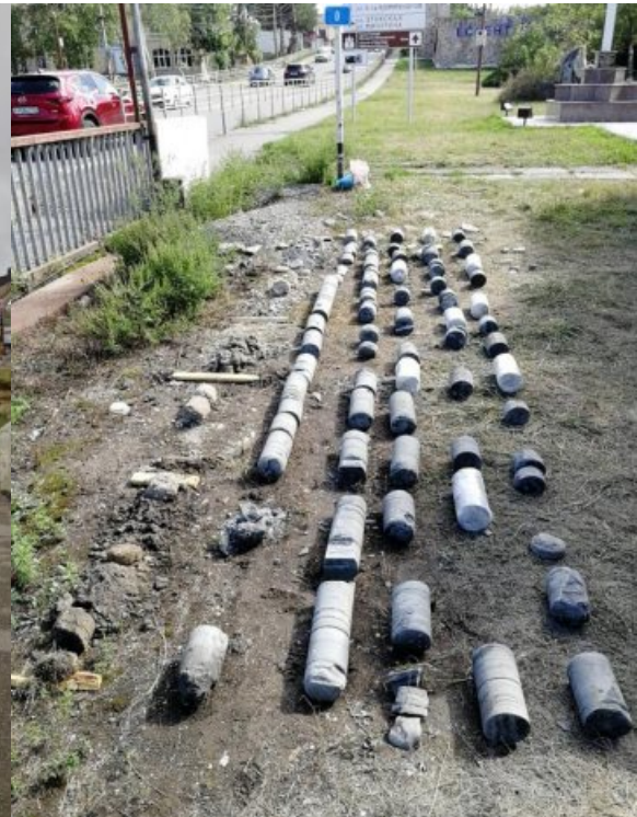
Фото 2. Керна выбуренный из С-1, буровой установкой УРБ-51
