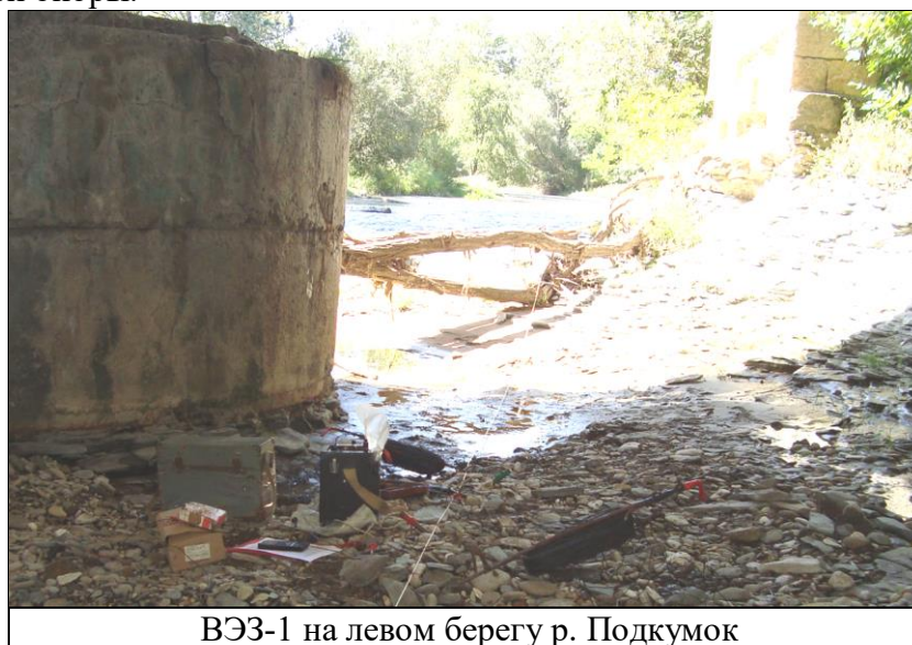
Рис. 3.1.2. Рабочий момент проведения полевых коррозионных измерений методом ВЭЗ
