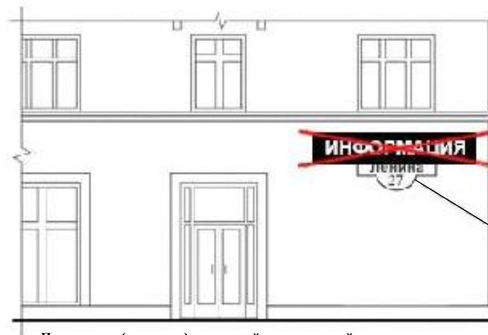
Перекрывтие (закрывтие) указателей наименований улиц и номеров домов
